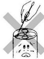
Не используйте иглы или другие острые предметы для удаления мусора из насадки для воздуха/воды. В противном случае возможна деформация насадки или ослабление ее крепления.
