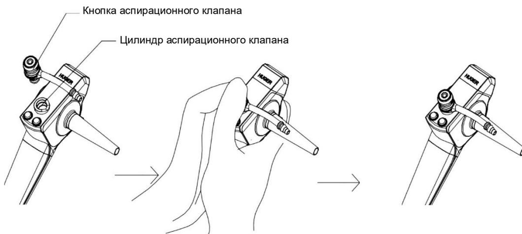
**Установка аспирационного клапана**
