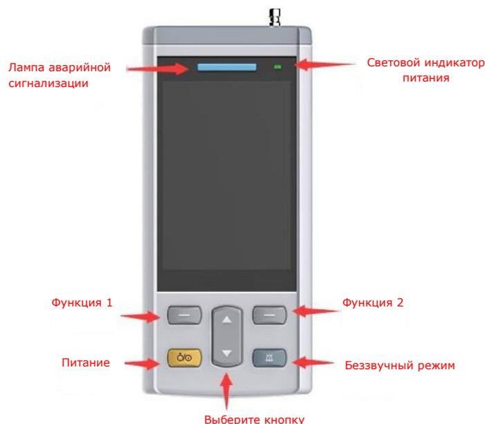
Рисунок 1-1 Переносное устройство для мониторинга жизненно важных функций
