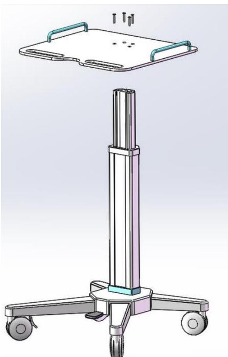
**Шаг 3:** Вставьте скользящий блок на задней стороне пластиковой корзины в паз на стойке с подъемным механизмом и затяните болты;
