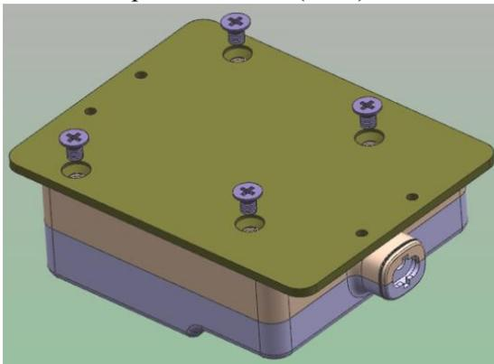
2. Вставьте два ползуна в пазы внешней стойки, а затем зафиксируйте заднюю панель на ползуне четырьмя крестообразными винтами с большой плоской головкой (M5x8)
