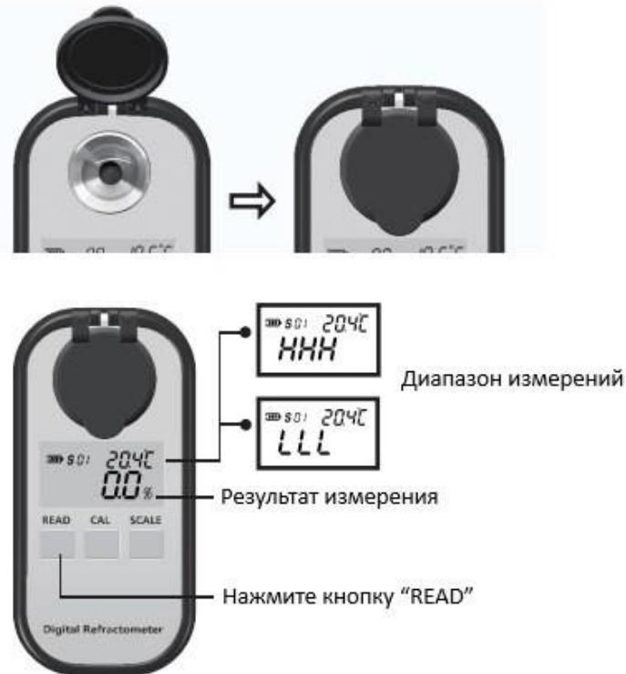
Если нажать кнопку "READ" в течение 2 секунд, прибор произведет автоматические измерения в запрограммированное время (по умолчанию 15 раз), конечным значением будет среднее значение за 15 измерений. После измерений многофункциональная область отображения вернется к состоянию отображения шкалы.
