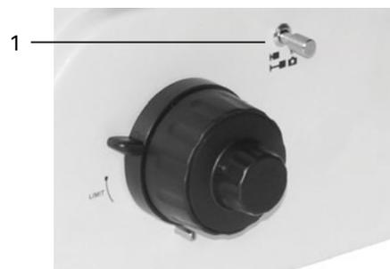
Рис. 5. Переключение канала визуализации
