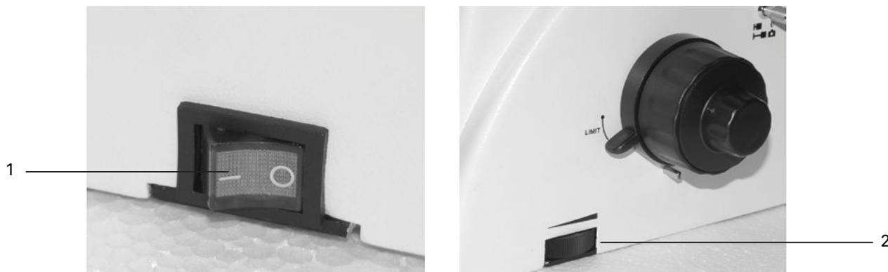
Рис. 4. Включение освещения и регулировка яркости горения лампы
