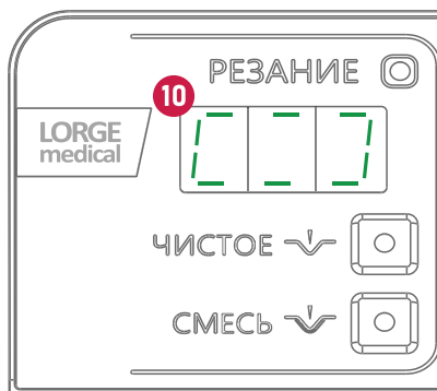
Рисунок 9 – Состояние индикатора мощности режима резание при правильном подключении односекционного НЭ
