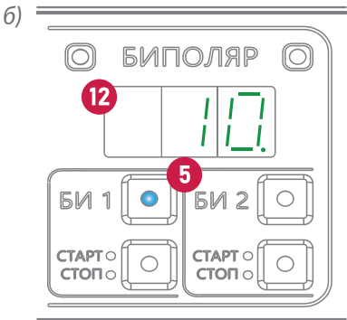
Рисунок 17 – Состояние индикации лицевой панели при выбранном режиме «БИ 1»: а) для исполнения «ALLIGATOR M1»; б) для исполнения «ALLIGATOR M2»;
